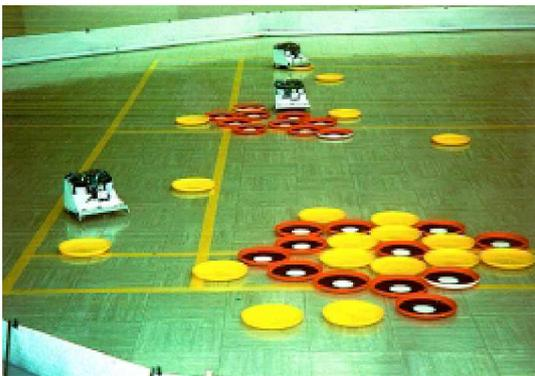
**Fig 3.5** Groupement de frisbees par un collectif de robots homogènes selon leurs couleurs.
