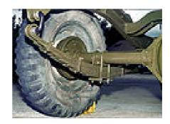
**Figure 1. 10** - Lames à extrémités paraboliques
