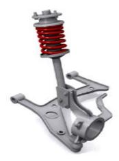
**Figure 1.1 -** Suspension de type Mc Pherson [5]
