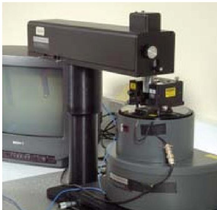
**Figure II.6. : Microscope à force atomique de type "Veeco autoprobe Cp".**
