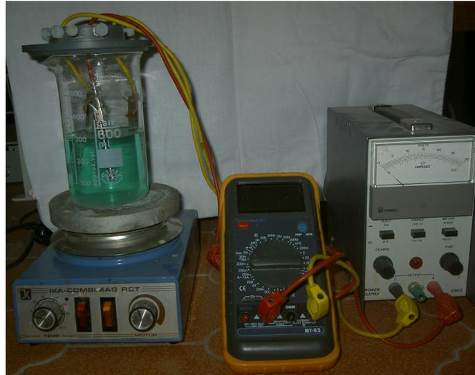
Figure II. 3. : Dispositif expérimental d'électrodéposition utilisé.
