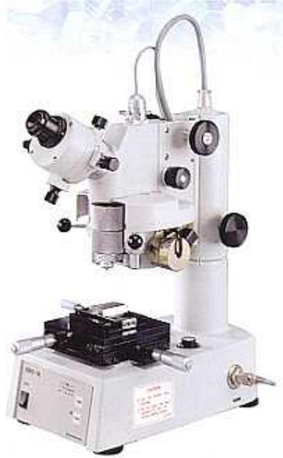
**Figure II.9. : Micro-duromètre de type Shimadzu HMV-M utilisé pour les mesures de dureté.**
