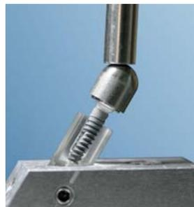
**Fig. I.15** : Essai de fatigue sous un angle latéral de 30° [9].
