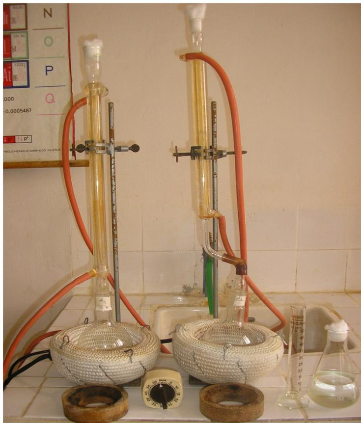
**Fig.19** : Photo présentant le dispositif expérimental (système à reflux) utilisé pour l'hydrolyse acide.
