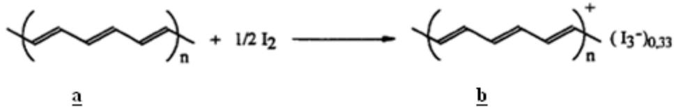
**Figure 4 :** Dopage chimique de type n de polyacétylène(PA)
