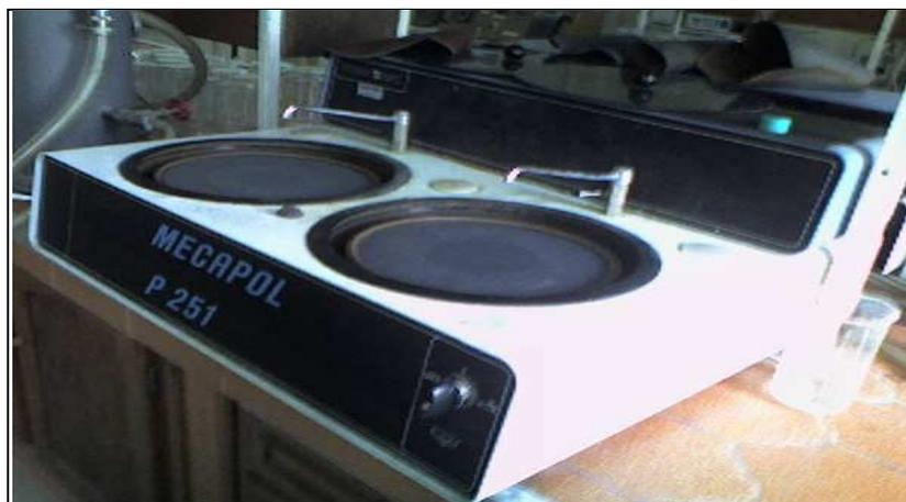
**Figure III.1** : Polisseur à disque (MECAPOLE 250).
