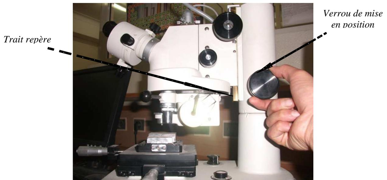
**Figure III.4:** Bouton de fixation en position.
