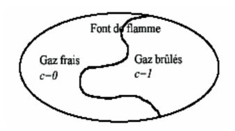
*Figure 2.2* Définition de la variable d'avancement [9].
