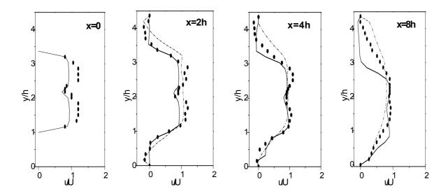
Figure 5 Comparaison de la vitesse longitudinal moyenne pour le cas inerte nc1 (Re=25000). LES Vitesse longitudinal moyenne; Expérimental vitesse longitudinal moyenne;  $k-\varepsilon$  Vitesse longitudinal moyenne.
