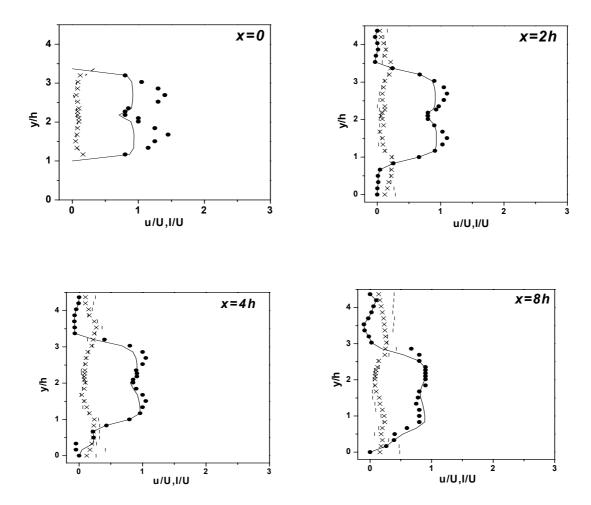
Figure 3.13 Comparaison de la vitesse longitudinal moyenne et la fluctuation vitesse longitudinal pour le cas nc1 (inert) (Re=25000). LES Vitesse longitudinal moyenne; Expérimental vitesse longitudinal moyenne; LES fluctuation vitesse longitudinal; X Expérimental fluctuation vitesse longitudinal.
