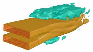
Figure 4 Visualisation 3D de la forme de l'écoulement et les zones de recirculation (inerte).
