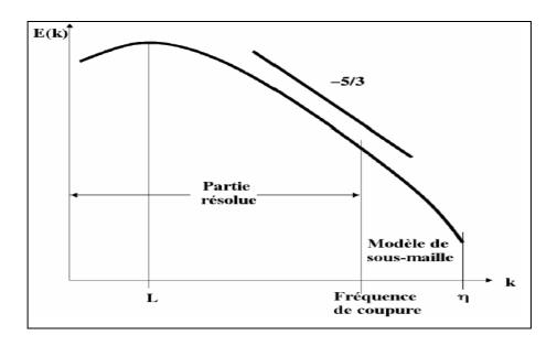
Figure 1. 2 Principe du modèle LES dans l'espace sur le spectre d'énergie [4].
