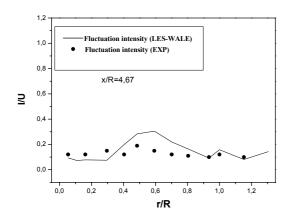
Figure 4.8(c). Profiles radiale de l'intensité turbulente de la vitesse axiale moyenne (x/R=4.67).
