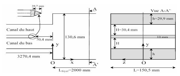
Figure 3.4 Dimensions caractéristiques du banc ORACLES.
