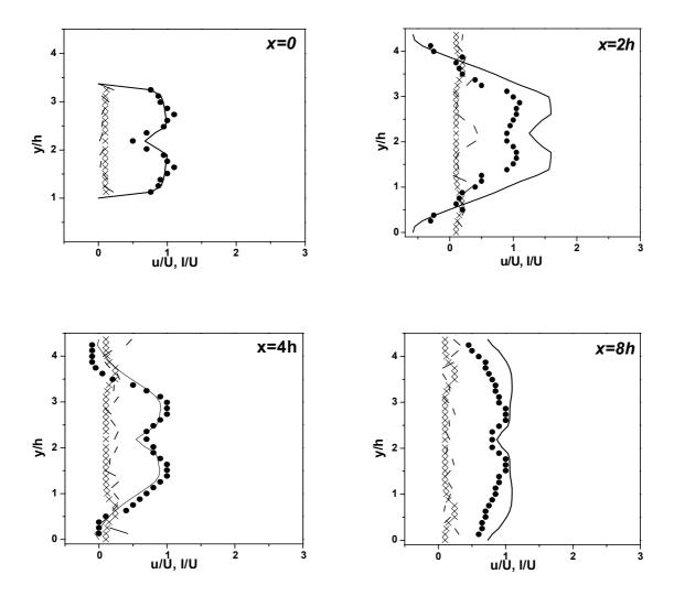
Figure 3.16 Comparaison de la vitesse longitudinal moyenne et la fluctuation vitesse longitudinal pour le cas h1 (Re=75000,  $\Phi$ =0.75). \_\_\_\_ LES Vitesse longitudinal moyenne;  $\bullet$  Expérimental vitesse longitudinal moyenne; \_\_\_\_ LES fluctuation vitesse longitudinal; X Expérimental fluctuation vitesse longitudinal.
