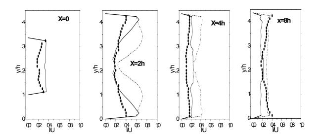
Figure 8 Comparaison de la vitesse longitudinal moyenne pour le cas c1 (Re=25000,  $\Phi=0,75$ ).
