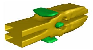
**Figure 3** Visualisation 3D du front de la flamme et les zones de recirculation (réactif).
