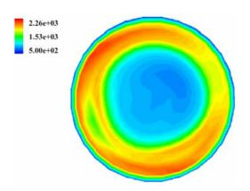
Figure 4.10(b. Profiles radiale de la température moyenne (x/R=1.57).
