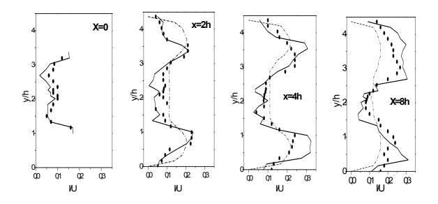
Figure 6 Comparaison de l'intensité turbulente de la vitesse longitudinal pour le cas nc1 (Re=25000).
