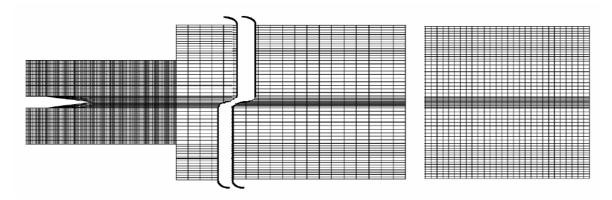
Figure 3.5 Maillage de la chambre de combustion
