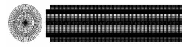
Figure 4.2 Maillage de la chambre de combustion
