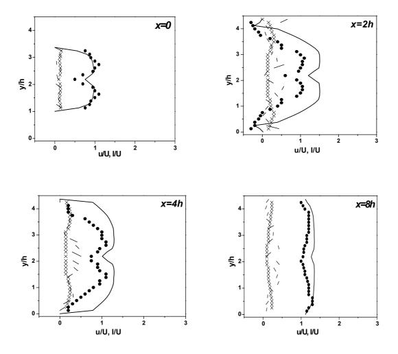
Figure 3.15 Comparaison de la vitesse longitudinal moyenne et la fluctuation vitesse longitudinal pour le cas h1 (Re=50000,  $\Phi$ =0.75). \_\_\_\_ LES Vitesse longitudinal moyenne;  $\blacksquare$  Expérimental vitesse longitudinal moyenne; \_\_\_\_ LES fluctuation vitesse longitudinal; X Expérimental fluctuation vitesse longitudinal
