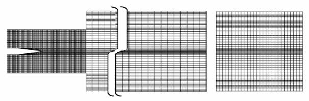
Figure 2 Maillage de la chambre de combustion
