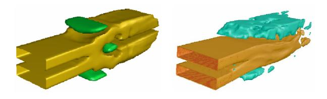
Figure 3.8 (a) Visualisation 3D du front de la flamme et les zones de recirculation (réactif).
