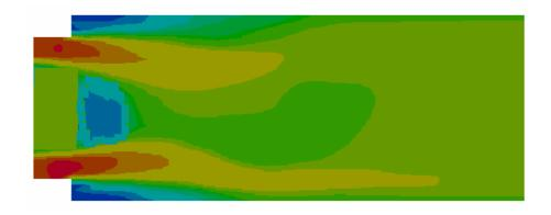
Figure 4.4 Champ de vitesse calculée par la simulation.
