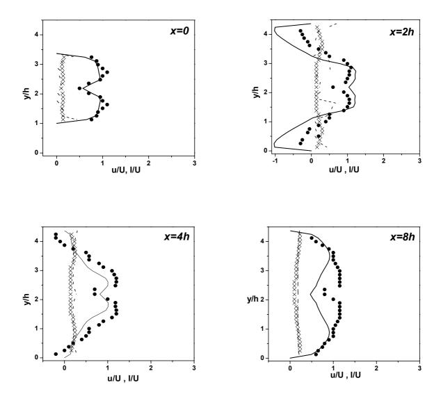
Figure 3.10 Comparaison de la vitesse longitudinal moyenne et la fluctuation vitesse longitudinal pour le cas c1.1 (Re=25000,  $\Phi$ =0.65).— LES Vitesse longitudinal moyenne; Expérimental vitesse longitudinal moyenne; ----LES fluctuation vitesse longitudinal; X Expérimental fluctuation vitesse longitudinal.
