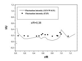
*Figure 4.8 (b).* Profiles radiale de l'intensité turbulente de la vitesse axiale moyenne (x/R=0.38).
