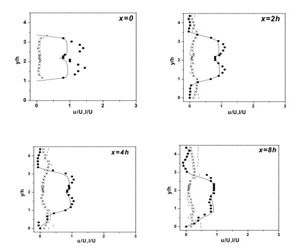
Figure 3.9 Comparaison de la vitesse longitudinal moyenne et la fluctuation vitesse longitudinal pour le cas nc1 (inert) (Re=25000). LES Vitesse longitudinal moyenne; Expérimental vitesse longitudinal moyenne; --- LES fluctuation vitesse longitudinal; X Expérimental fluctuation vitesse longitudinal.
