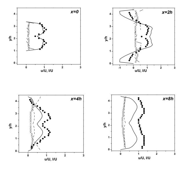
Figure 3.11 Comparaison de la vitesse longitudinal moyenne et la fluctuation vitesse longitudinal pour le cas c1.2 (Re=25000,  $\Phi=0.70$ ). — LES Vitesse longitudinal moyenne; Expérimental vitesse longitudinal moyenne; ---- LES fluctuation vitesse longitudinal; X Expérimental fluctuation vitesse longitudinal.
