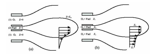
Figure 2.1 Exemple de l'injection séparée (a) non-prémélangée ; (b) prémélangée [9].
