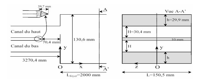
Figure 1 dimensions caractéristiques du banc ORACLES.
