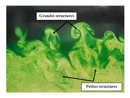
**Figure 1.1** La visualisation des structures à grande échelle et petites échelles qui apparaissent dans la plupart des aspects fondamentaux des écoulements turbulents.
