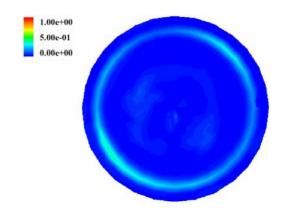
Figure 4.9(a). La distribution l'intensité turbulente de la vitesse axiale (x/R=0.14).
