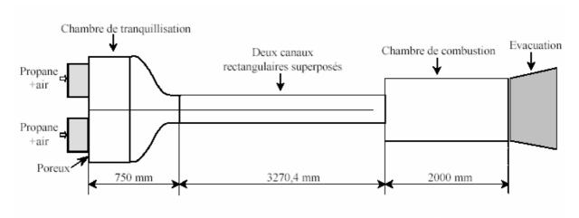
Figure 3.1 Constituants principaux du banc d'essai [3]
