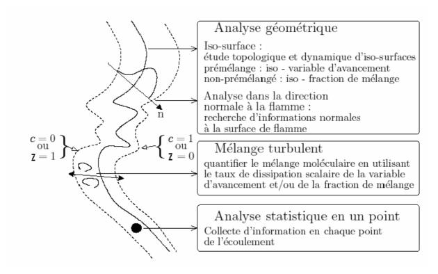
*Figure. 2.3* Trois types d'analyses des flammes turbulentes prémélangées ou non-prémélangées [70].
