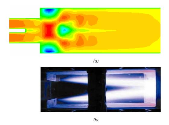
**Figures 3.7** Visualisations de front de flamme ; (a)simulation, (b) expérimentale de Nguyen et al. [3].
