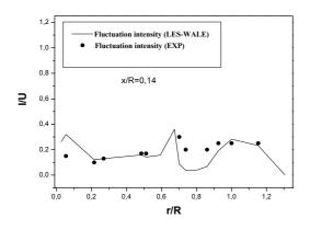
Figure 4.8(a). Profiles radiale de l'intensité turbulente de la vitesse axiale (x/R=0.14).
