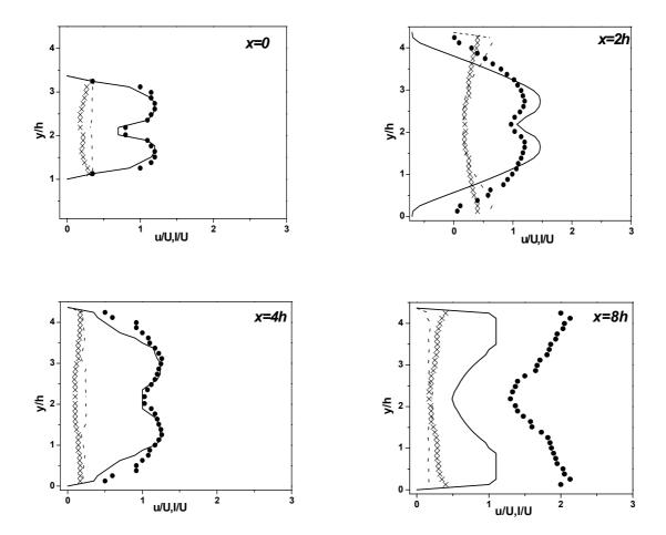
Figure 3.12 Comparaison de la vitesse longitudinal moyenne et la fluctuation vitesse longitudinal pour le cas c1 (Re=25000,  $\Phi=0.75$ ). LES Vitesse longitudinal moyenne; Expérimental vitesse longitudinal moyenne; LES fluctuation vitesse longitudinal; X Expérimental fluctuation vitesse longitudinal
