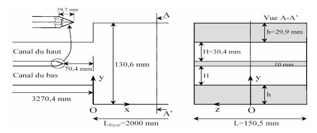
Figure 1 dimensions caractéristiques du banc ORACLES.
