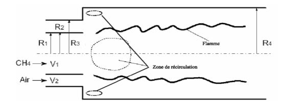
Figure 4.3 Schéma présent les observations de l'expérience [47].
