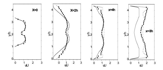
Figure 7 Comparaison de la vitesse longitudinal moyenne pour le cas c1 (Re=25000,  $\Phi=0,75$ ). LES Vitesse longitudinal moyenne; Expérimental vitesse longitudinal moyenne;  $k-\varepsilon$  Vitesse longitudinal moyenne.
