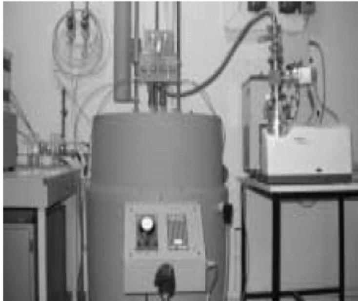
**Fig.6-3** : Calorimètre HT1000 avec introducteur d'échantillon thermostaté [62].
