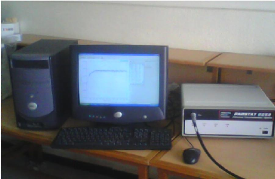
Figure IV.3: Potentiostat/Galvanostat pilotée par microordinateur à l'aide d'un logiciel Power SUITE.
