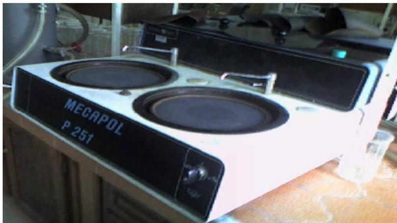
*Figure IV.12: Polisseur à disque (MECAPOLE 250)*
