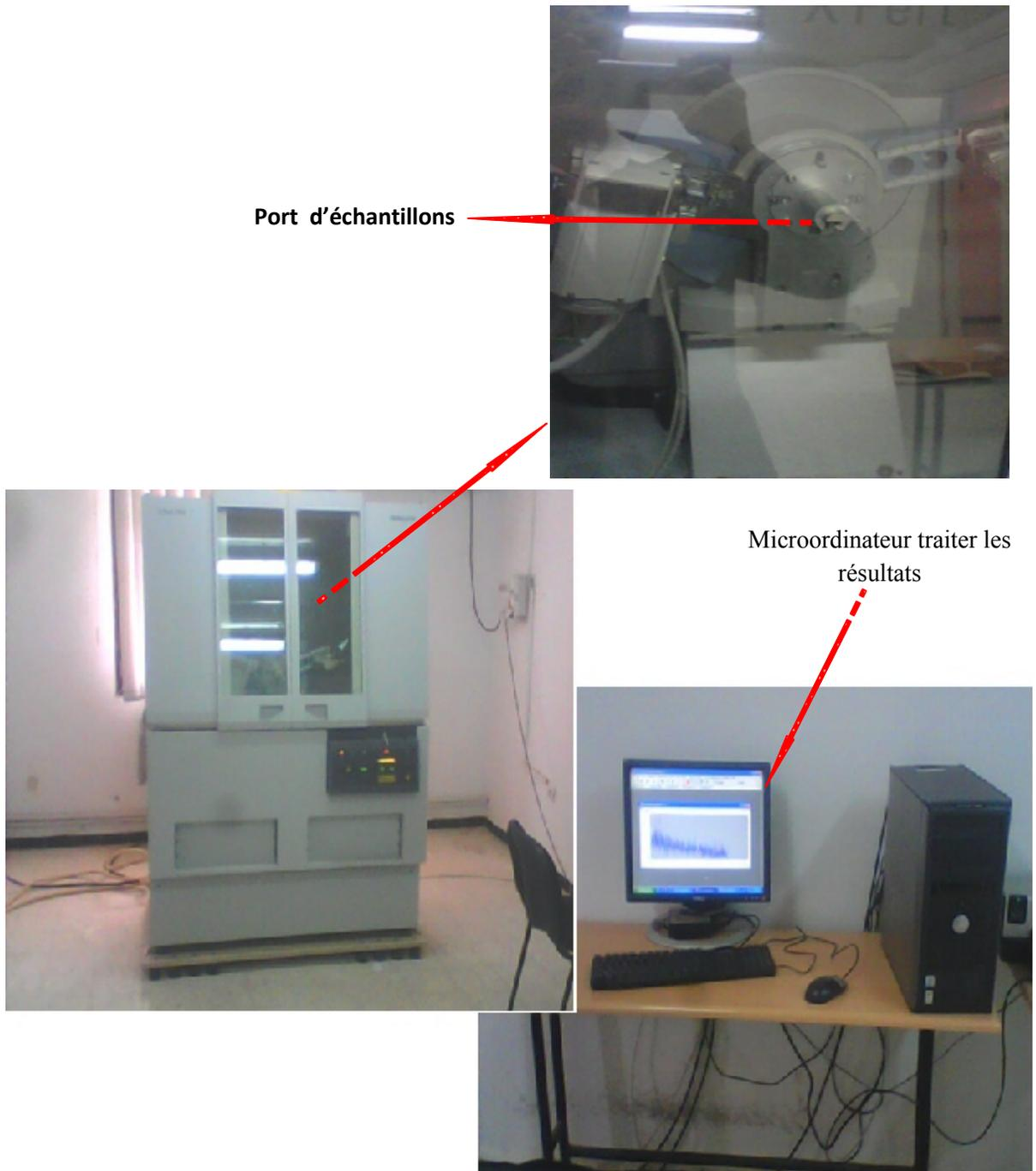
Figure IV.10: diffractomètre de rayons X, model X'Port PRO
