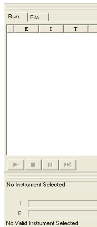
L'expérience est lancée avec la touche « **Run** ». La touche « **skip** » sert à supprimer un temps en train de s'écouler (cf « **PreScan Definition** ») pour passer au démarrage de l'expérience. La touche reverse, elle, n'est disponible que pour PowerSINE® et sert à inverser le sens de balayage en fréquence.
