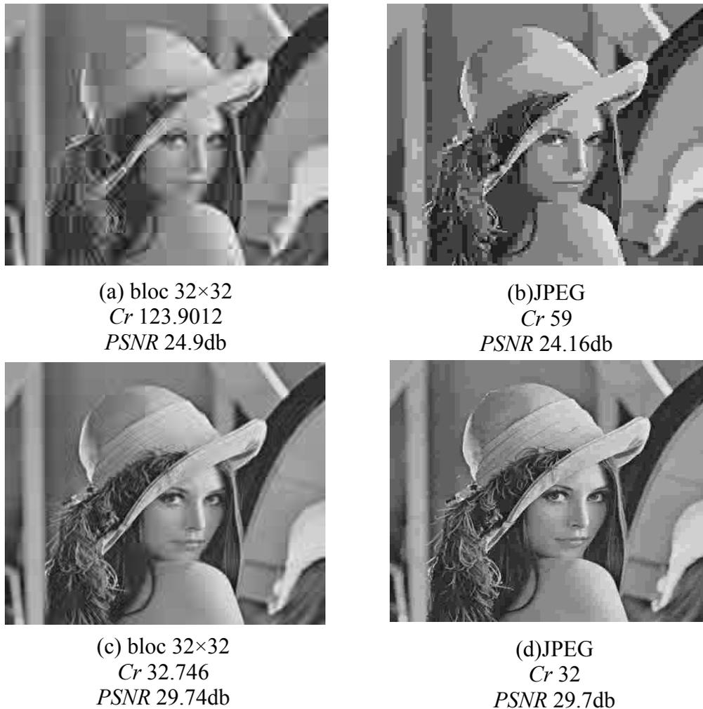
**Figure IV.3** Résultats d'application de JPEG et notre méthode sur l'image de "Lena"
