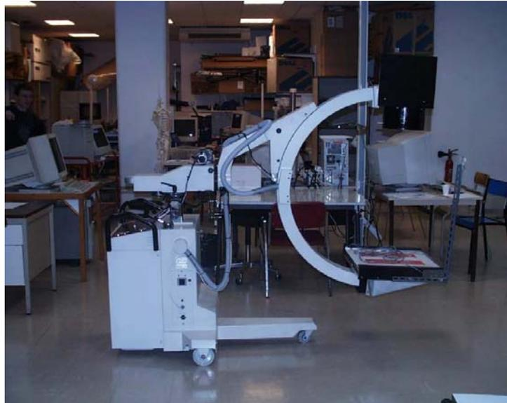
**Figure I.5** C-arm : dispositif léger et mobile pour faire de la radiographie en salle d'opération [21]
