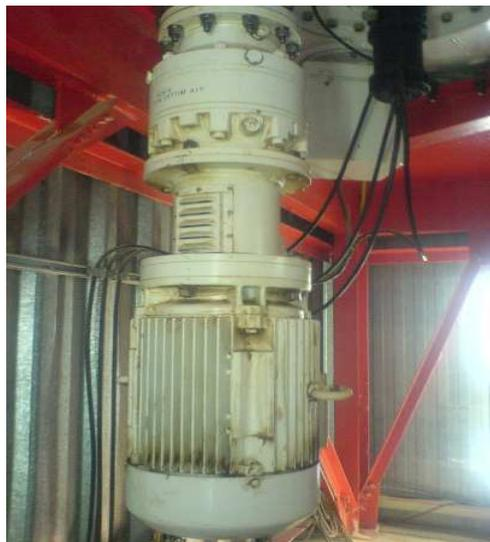
Figure II.9 : Moteur tournant l'antenne (photo prise à la station radar d'Eloued)
