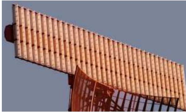
Figure I.3 : Antenne radar primaire celle en bas ([www.radartutorial.eu](http://www.radartutorial.eu))
