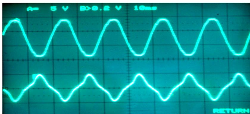
**Figure (IV.32.A.B) Caractéristiques,  $U(t)$  et  $I(t)$  aux points de résonance.**
