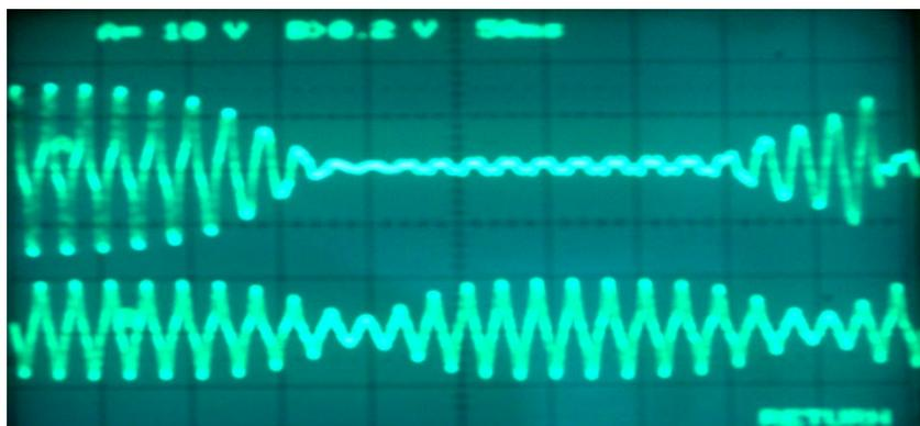
*Figure (IV.36.A.B) Caractéristiques  $V(t)$  et  $I(t)$  en régime de fonctionnement du moteur.*
