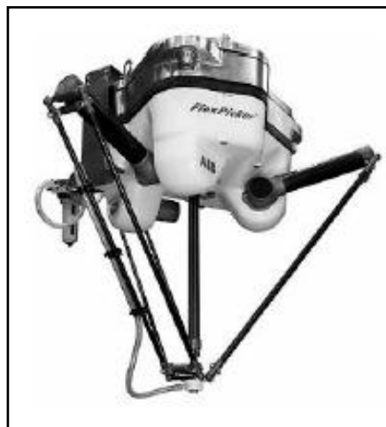
Figure I. 13 : Le Delta utilisant des actionneurs rotatifs en partis haute
