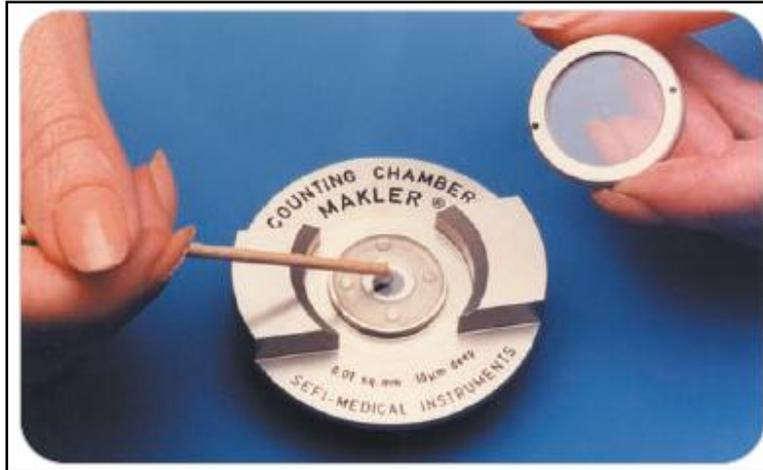
Cellule de comptage à profondeur déterminée pour l'obtention d'une monocouche de spermatozoïdes.
