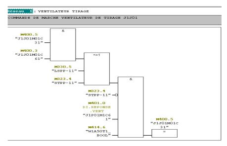
Figure 6.8: Commande de marche de ventilateur de tirage
