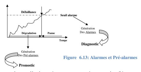
Les pré-alarmes permettent le contrôle du système et processus à travers des éléments clignotants. Ces derniers déclenchent des alarmes qui sont journalisées dans la liste des alarmes, mais les informations relatives à ces alarmes sont stockées dans la base de données des événements.
