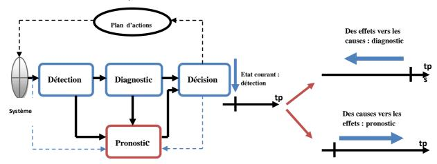
Figure 1.8: a- Détection, Diagnostic et Pronostic b- Détection, Diagnostic et Pronostic dans les systèmes de maintenance intelligente
