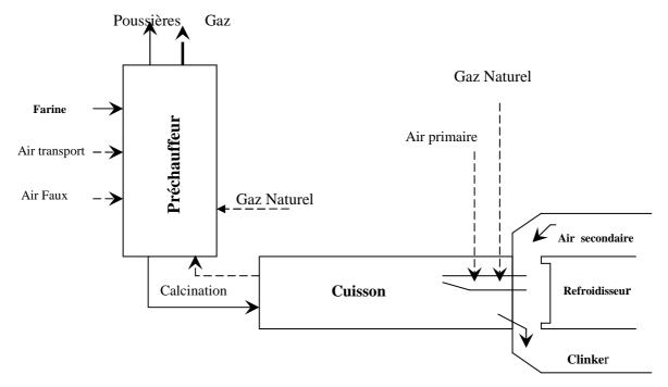
Figure 5.2: Zones de réaction du Four Rotatif
