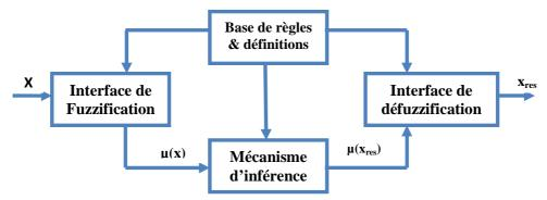
Figure 2.1: Structure d'une commande floue
