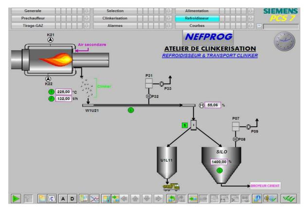
Figure 6.47: Refroidissement et stockage Clinker
