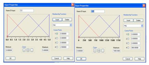
Figure 5.6: Fonctions d'appartenance de %O<sub>2</sub> et NOx
