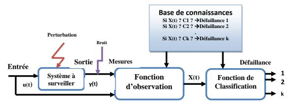
Figure 1.7: Structure d'un système de diagnostic par Reconnaissance des Formes
