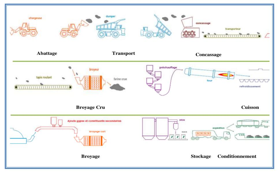
Figure 3.1 : Schéma synoptique du process de fabrication du ciment
