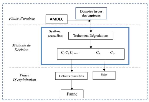
Figure 5.3: Pronostic industriel par RdF Neuro-Floue
