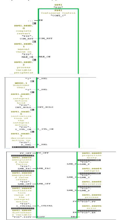
Figure 6.17: Bloc d'un régulateur classique
