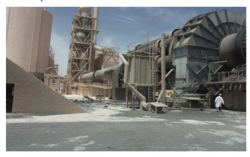
Figure 5.1: Four Rotatif de la SCIMAT
