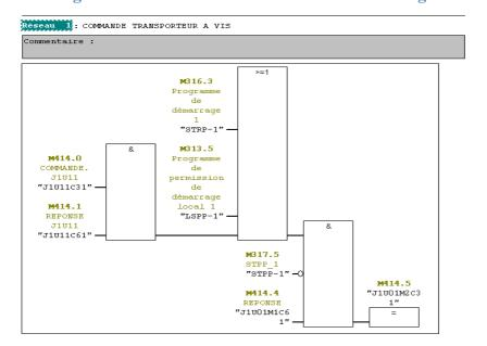
Figure 6.10: Commande de marche de transporteur à vis
