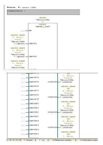
Figure 6.27: Bloc d'un régulateur Neuro-Flou
