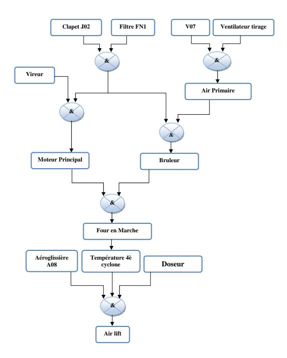
Figure 6.11: Séquence de démarrage de l'atelier de clinkérisation
