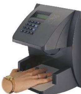
En général, une caméra infrarouge prend l'image de la main sous deux angles différents pour obtenir les trois dimensions comme l'illustre la photographie ci dessous. Les mesures qui sont faites ne prennent que les dimensions de certaines parties de la main et non la pigmentation de la peau ou les lignes situées au niveau des articulations. Le gabarit qui en résulte est d'une taille très faible, une dizaine d'octets, et permet de faire de l'authentification.
