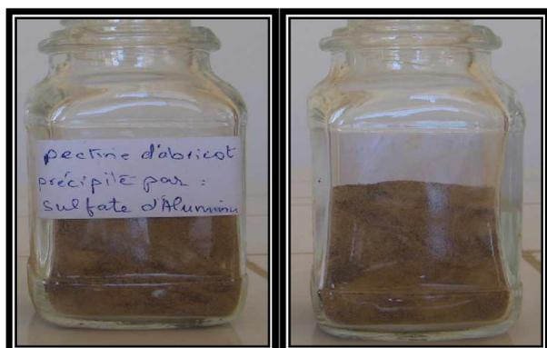
**Photo 7 :** Pectines d'abricots précipitées au sulfate d'aluminium
