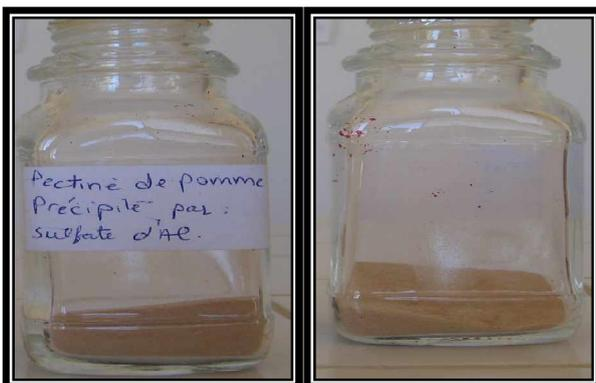
**Photo 9:** Pectines pommes précipitées au sulfate d'aluminium
