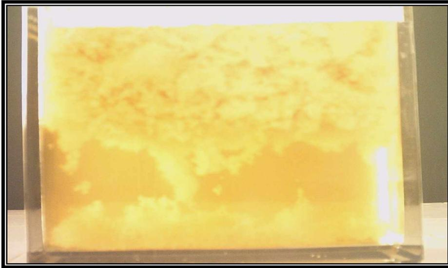
§ *Photo 1: Précipitation des pectines d'oranges par les solvants à base d'aluminium*
