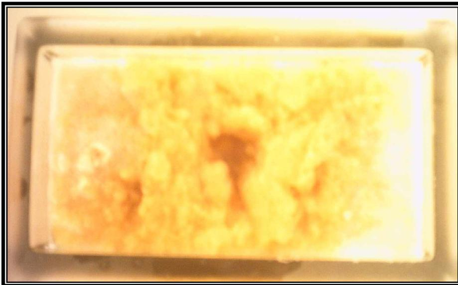
§ *Photo 2 : Précipitation des pectines d'abricots par les solvants à base d'aluminium*
