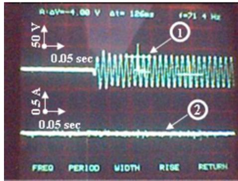
Fig. (2.37a) Résultat expérimental de la tension du stator (1) et le courant du stator (2), 1600 tr/min, à vide
