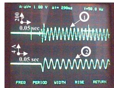
Fig. (5.10a). Résultats expérimentaux de la tension du stator (1) et du courant de rotor (2), pou 2400 tr/m
