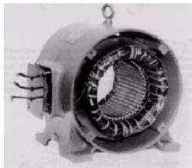
Fig. (2.1) Stator du moteur à induction
