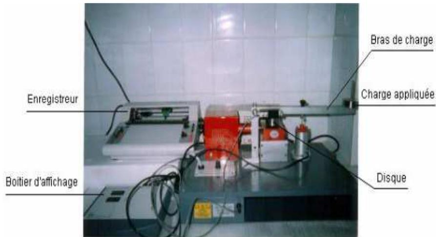
Figure 2.2 : Tribomètre de type TE91.
