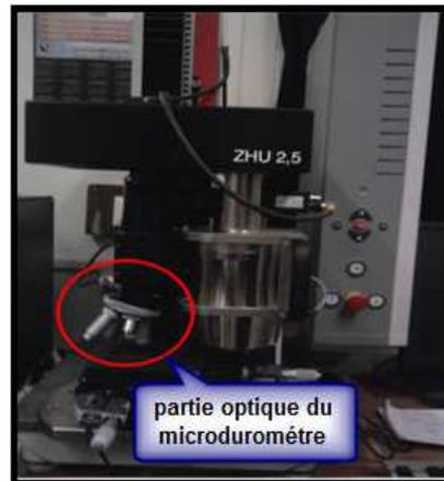
Figure 2.1 : Photographie du microduromètre Zwick Roell utilisé.
