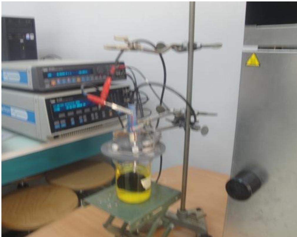
**Fig.III.4. Photographie du dispositif de mesures électrochimiques.**
