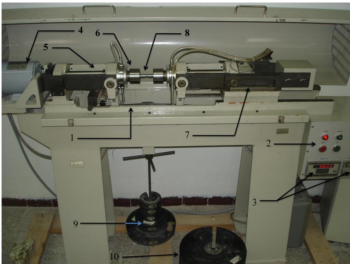
**Figure III.2.1** La machine d'essai de fatigue SHIMADZOU FREQUOL-Z200
