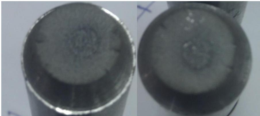
**Figure IV.6** éprouvette N° 2 rompue de 36800 (cycles) à  $174 \text{ N/mm}^2$
