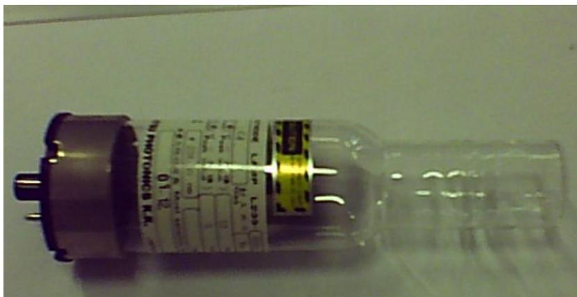
**Photo6** : Une lampe à cathode creuse
