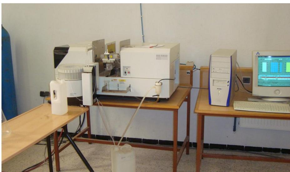
**Photo10:** Spectrophotomètre d'Absorption Atomique de type Shimadzu AA 6800.
