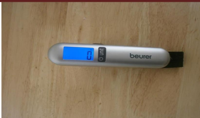
**Figure 10** : Balance mobile de 40 kg
