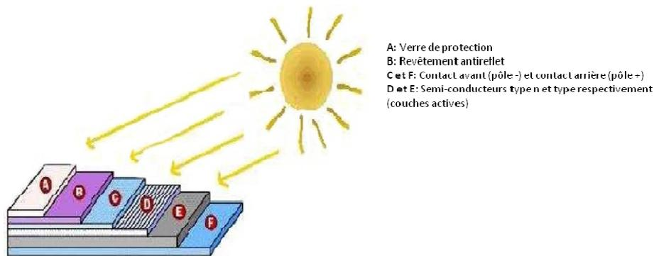
FIGURE 2.1 – Structure d'une cellule photovoltaïque
