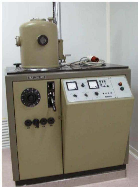
FIGURE 5.2 – L'évaporateur thermique utilisé pour réaliser les couches mince de ZnS
