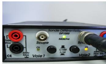
Figure A.3 : Photo de la sonde différentielle
