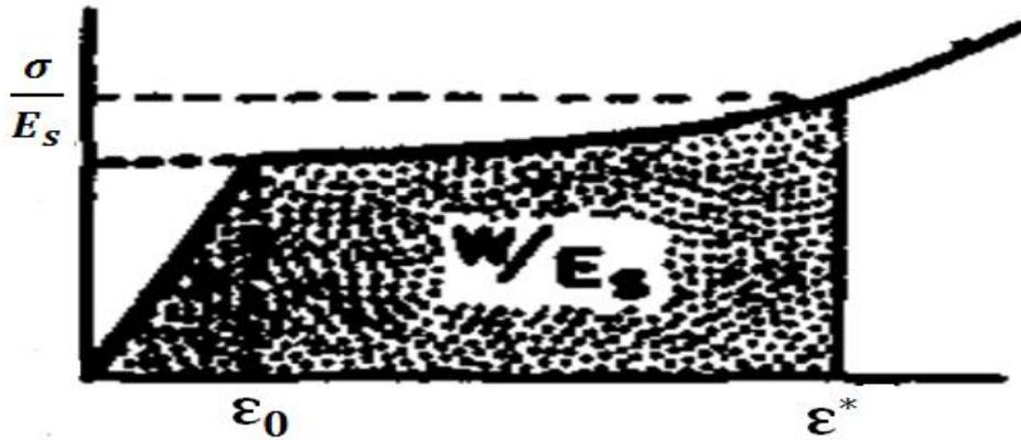
Fig 2.22: Courbe contrainte-déformation pour un matériau cellulaire.
