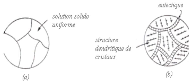
Figure (I-19) : la microstructure de  $C_7$  après la solidification. [WNG.2000]
