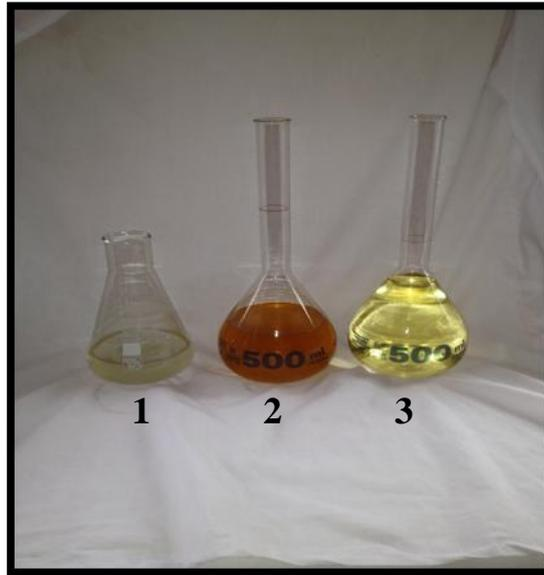
1. Concentrât de l'eau désionisée, 2. concentrât de l'eau réelle, 3. concentrât de l'eau de perméat de Nanofiltration
