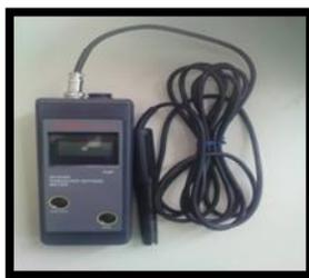
**Figure II.1.3 : Oxymètre**
