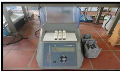
Figure II.1.11 : Réacteur programmable pour les analyses de DCO
