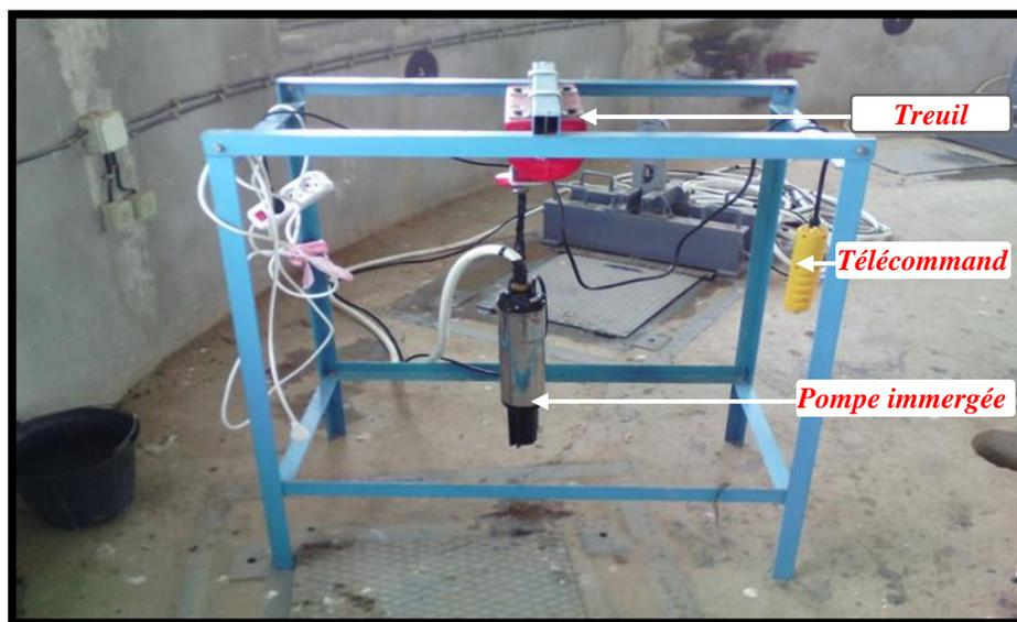
Figure II.1.13 : Photo du système d'échantillonnage conçu et réalisé par le candidat
