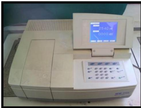
Figure II.1.10 : Spectrophotomètre UV-Visible
