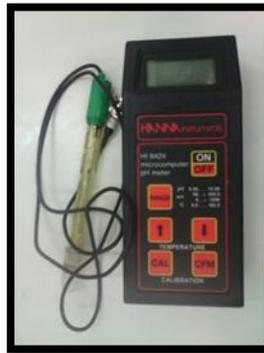
**Figure II.1.9 : pH mètre portable**
