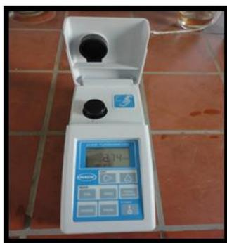
**Figure II.1.4 : Turbidimètre**
