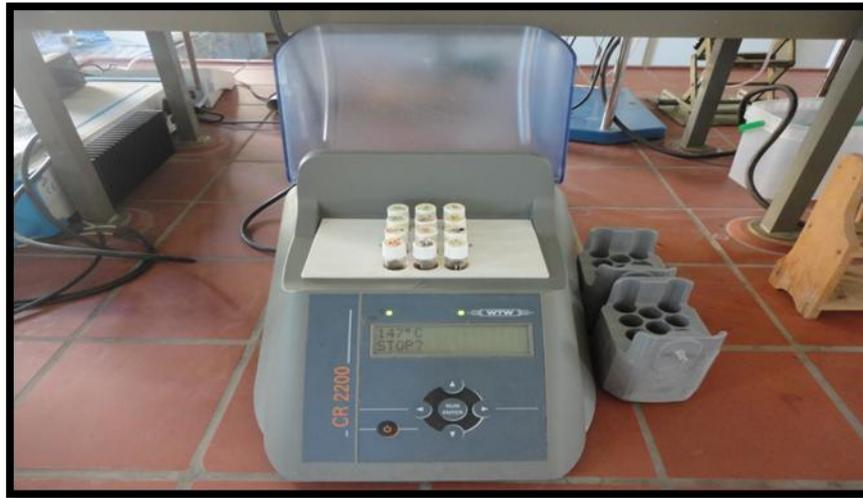
**Figure II.1.2 :** Réacteur programmable pour les analyses de DCO.
