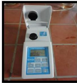
Figure II.1.5 : Turbidimètre.
