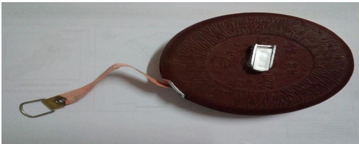
**Figure n°24** : Photo d'un ruban mètre de 30 m utilisé pour déterminer la surface du relevé
