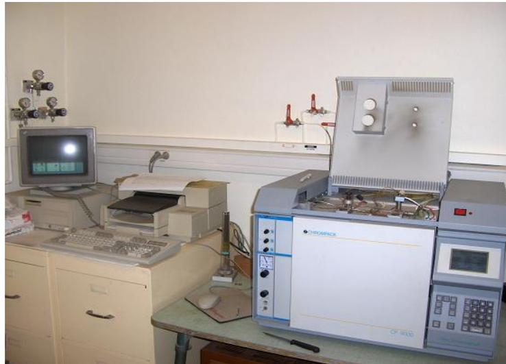
***Figure 15: Chromatographie gaz liquide (GLC) utilisé pour analyser des acides gras***
