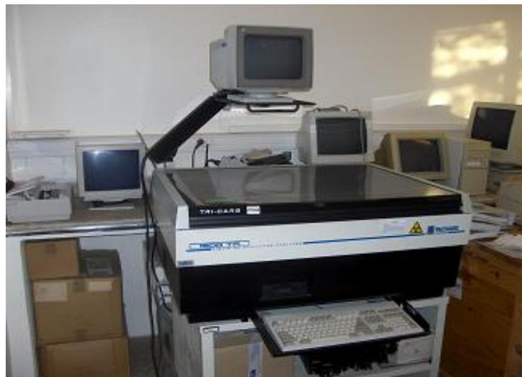
**Figure 13 :** *Spectromètre  $\beta$  (Packard 460) utilisé pour mesurer la radioactivité.*
