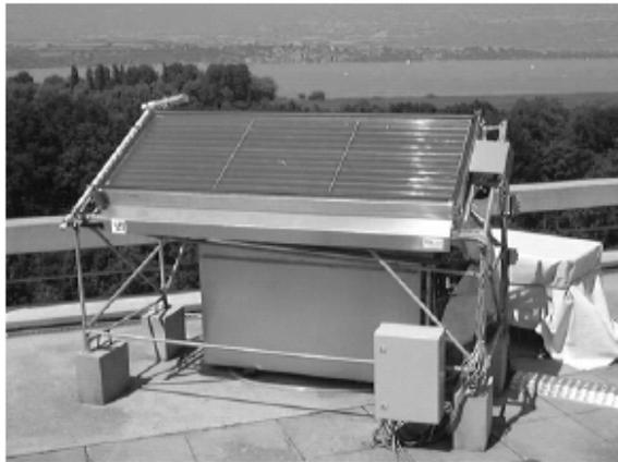
Figure 1.7 : Photo et plan du réfrigérateur solaire [6]
