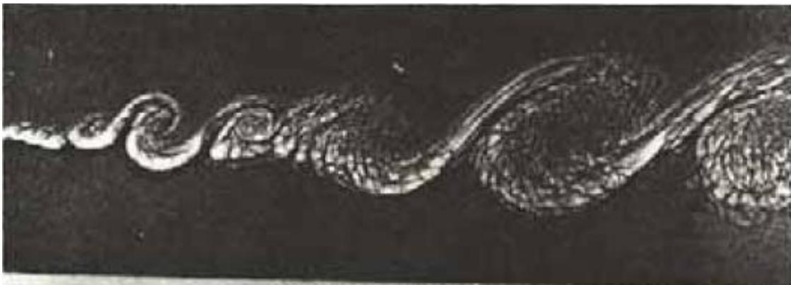
**Fig.1.3-** Visualisation strioscopique de la zone de mélange entre un courant d'hélium (1) à 1 m/s et un courant d'azote (2) à 3.78 m/s.
