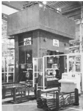
**Figure 1.12: Presse d'hydroformage de 50 000 KN (SPS, Germany) [Lan04a].**
