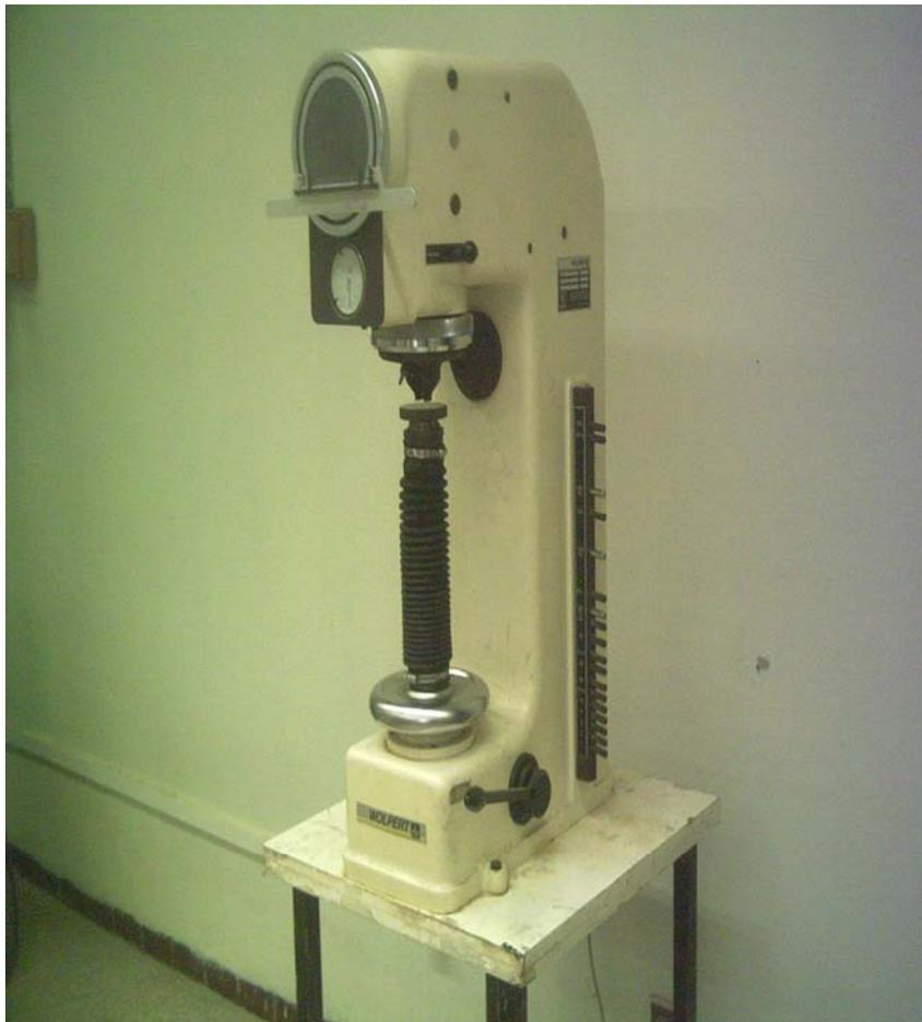
**Photo (02)** : le duromètre.
