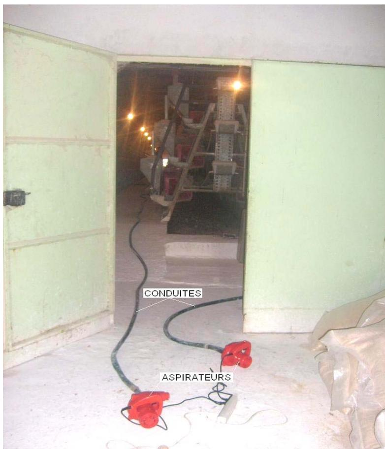
Photo N °15 : Pilote captage actif des poussières (partie se trouvant à l'extérieur du bâtiment).
