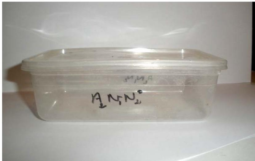
Photo N° 13 : Boite utilisée dans le captage passif des poussières.
