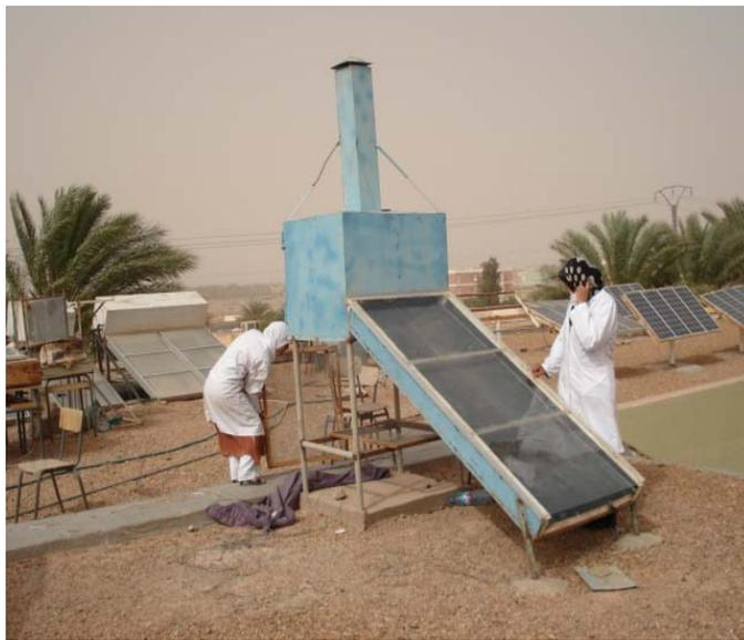
Figure 3.2 séchoir solaire indirect passif ou naturel
