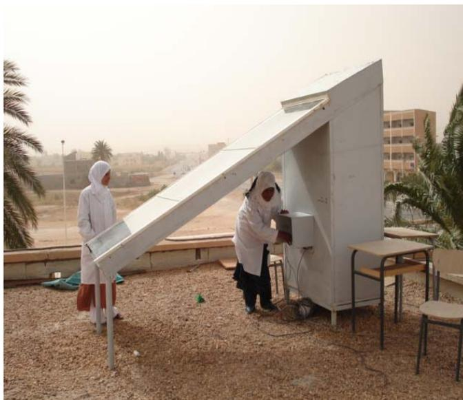
Figure 3.3 Séchoir solaire indirect actif ou forcé.
