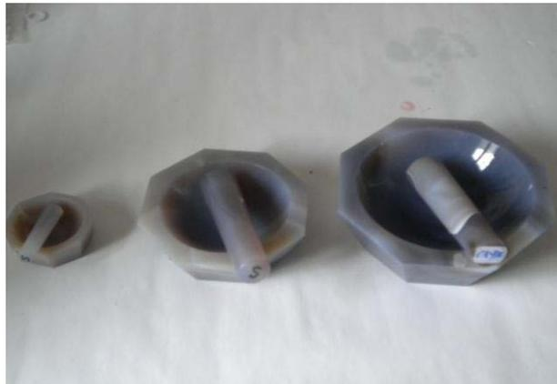
**Figure II.2.2.** Photo de trois mortiers en agate avec pilons pour le broyage des réactifs.
