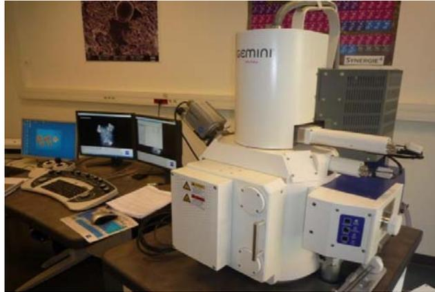
La figure II.2.13 : Image d'un le microscope Electronique à Balayage
