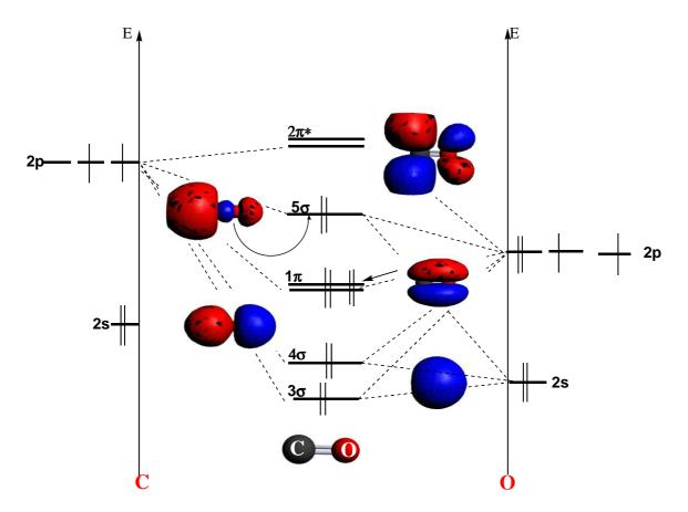
Figure7: Diagramme orbitalaire du carbonyle.
