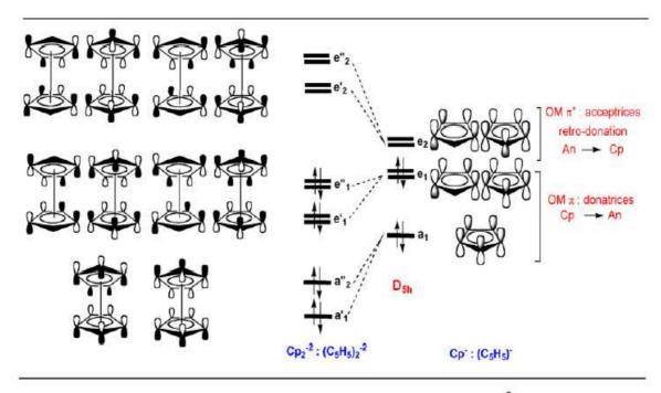
**Figure 4 :** Diagramme des OM  $\pi$  du ligand  $C_5H_5^-$  et de l'entité  $(C_5H_5)_2^{-2}$  en symétrie  $D_5h$
