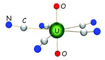
**Figure 3.** structure moléculaire de  $[UO_2(CN)_5]^{3-}$ .
