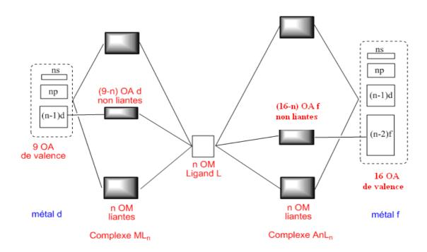
Figure 2 : Diagramme qualitatif des OM de complexes ML<sub>n</sub> (M = métal nd, An actinide)
