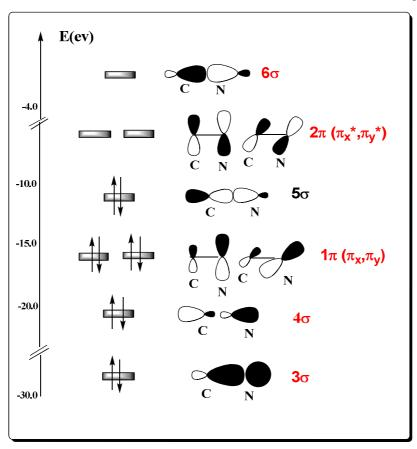
Figure 6 : Diagramme d'énergie des O.M. de l'ion cyanure CN-
