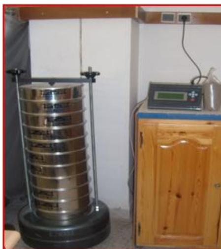
Photo. VII.1. Appareillage pour essai de l'analyse granulométrique.
