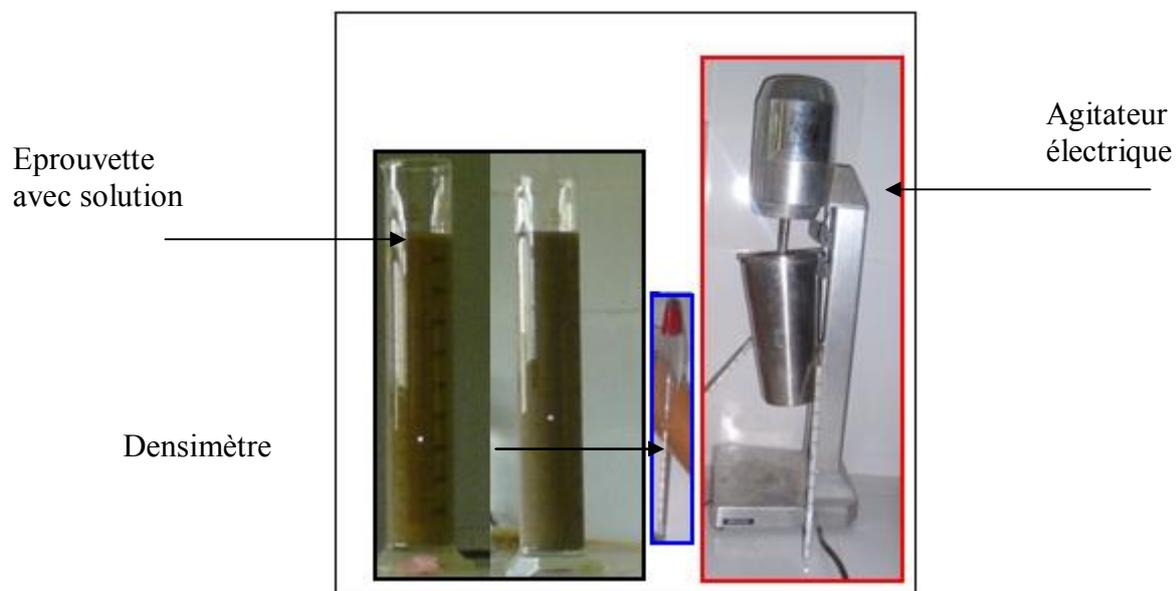
*Photo. VII.04. Appareillage pour essai de l'Analyse sédimentométrique.*
