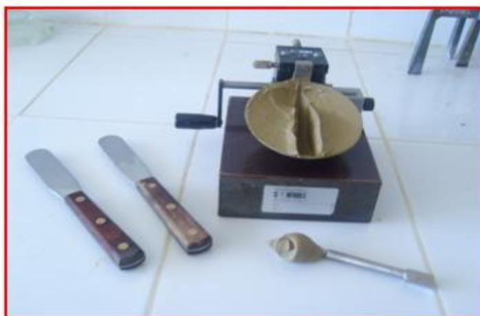
Photo. VII.2. Essai de la limite de liquidité à la boîte de Casagrande.
