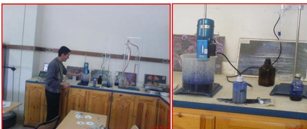
Photo. VII. 5. Appareillage pour essai au bleu de méthylène
