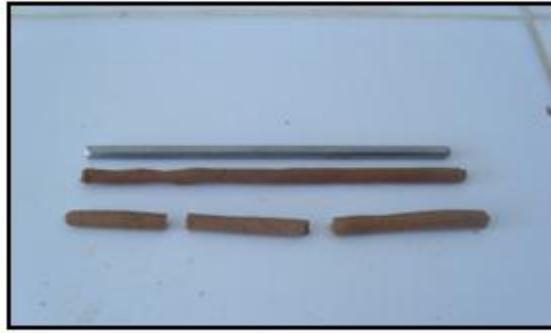
Photo .VII.3.Essai de la limite de plasticité.
