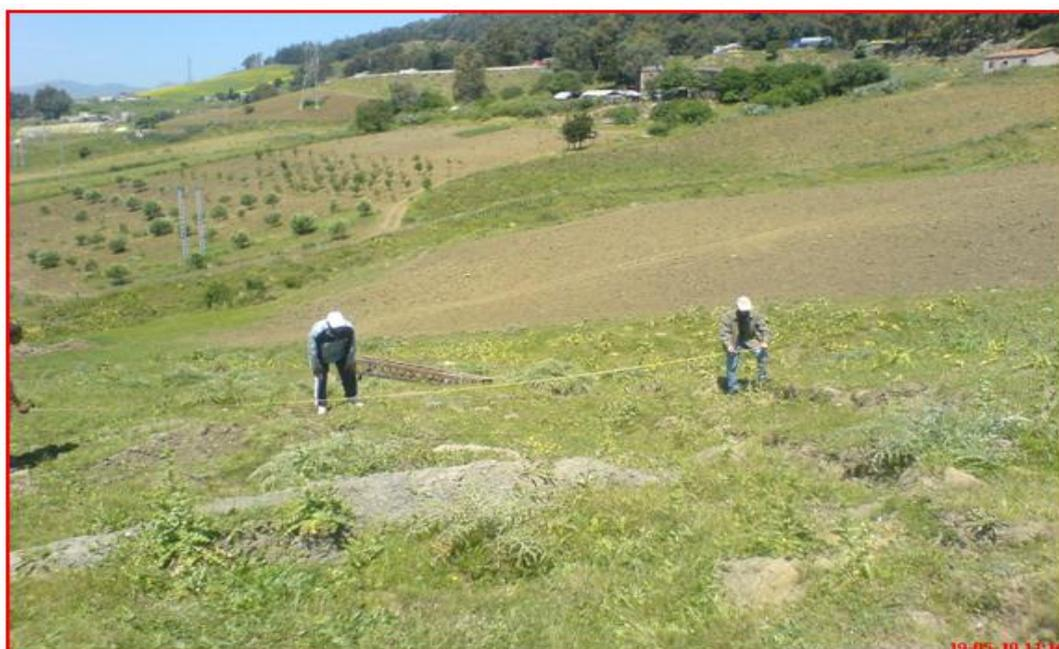
Photo. IV .5. Application de la méthode de Crozier sur le glissement d'El Kantour ( 19/05/2010 - 11<sup>h</sup> :14)
