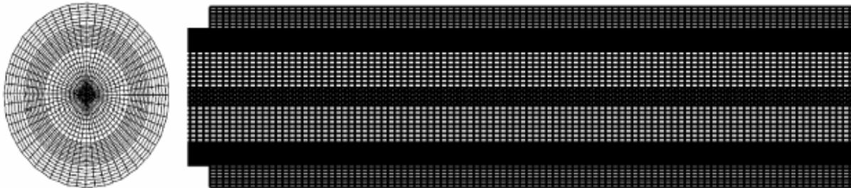
Figure 4.2 Maillage de la chambre de combustion
