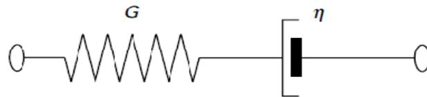
**Figure I-9-** Modèle de Maxwell.
