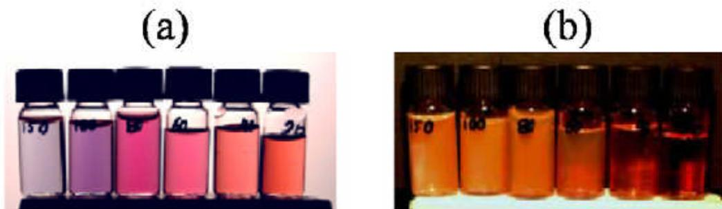
Fig. 1.7: Photographie en lumière blanche, en transmission (a) et en réflexion (b), de solutions colloïdales contenant des nanoparticules sphériques de différentes tailles. [7].
