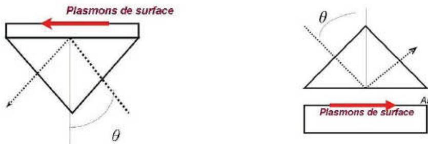
Figure 1.4 : Représentation des deux méthodes dites ATR: à gauche, configuration de Kretschmann-Raether, à droite, configuration d'Otto.
