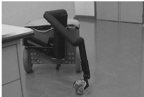
**Figure I.10 :** Le robot ARPH est composé d'une plate-forme mobile sur laquelle est embarqué un bras manipulateur. Son but est d'augmenter l'autonomie des personnes à mobilité réduite.
