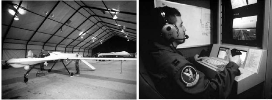
**Figure I.3 :** Le UAV Predator transporte une grande variété de capteurs (EO, IR, SAR) et est piloté par un opérateur au sol via une liaison radio ou satellite. Il peut exécuter un plan de vol de manière totalement autonome une fois celui-ci implémenté à bord.
