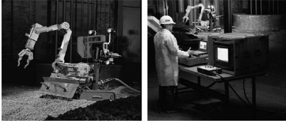
**Figure I.7 :** Le robot Pioneer a été conçu pour inspecter et diagnostiquer l'état du réacteur nucléaire de Chernobyl.
