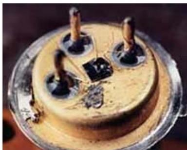
**Figure I.1 Le premier transistor MOSFET, conçu par MM Atalla, D. Kahng [4]**
