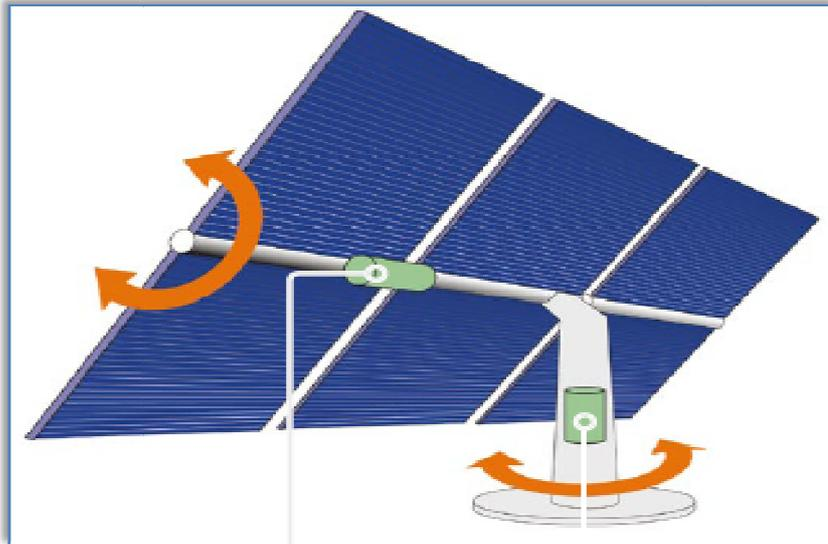
Figure II.4 : Système de poursuite à deux axes
