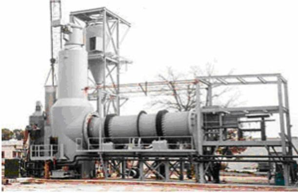
**Figure I-2 :** Four rotatif à incinération équipé d'une seconde chambre de combustion verticale.
