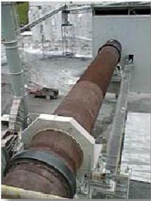
*Figure I-1 : La taille du four à chaux de 500 t/j peut être jugée à partir du camion à gauche du four.*
