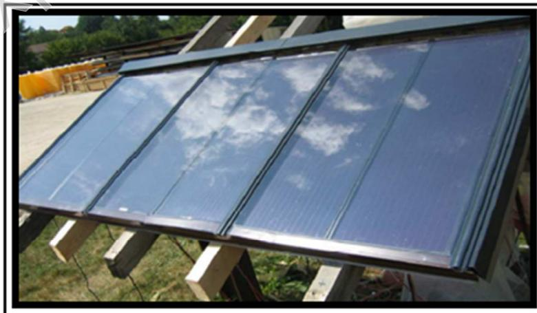
**Figure 3-15: Le capteur solaire PV/T hybride à eau [2]**
