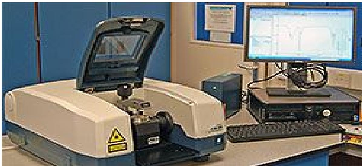
**Figure III.5:** Spectromètre infrarouge à transformée de fourrier IR
