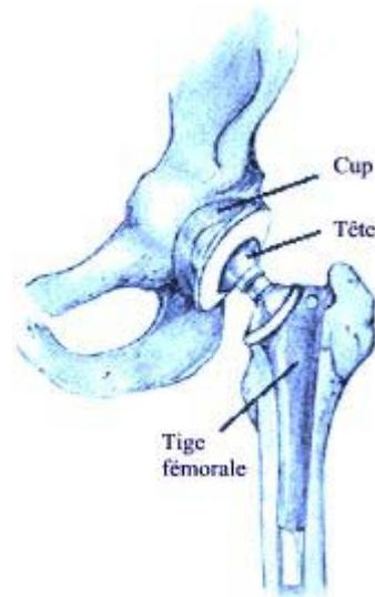
Figure 3.1. Schéma de prothèse totale de hanche
